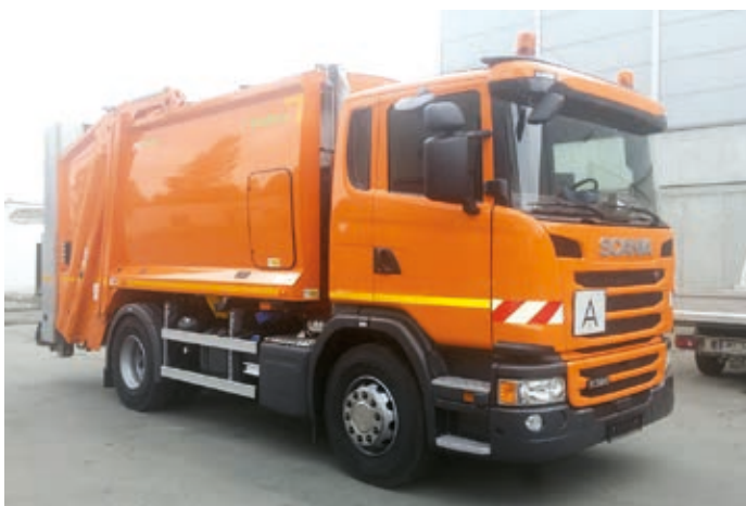
Technické detaily nového vozu: SCANIA G320, DB4x2, 18 t, EURO 6 / RosRoca OLYMPUS 14W (14 m³). Foto: Ekoltes
